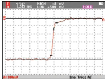
Длительность фронта импульса у прибора позволяет точно записывать сигналы с коротким фронтом и признаками отражений.
