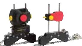
Получение моментальной проверки замеров при вращении вала
