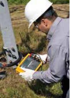
Зашелкнуть трансформатор с разрезным сердечником на опоре линии электропередач для измерения контура заземления
