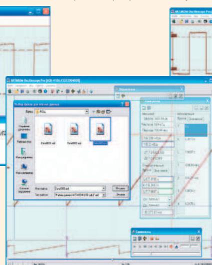
Чтение файла самописца и полупрозрачная панель измерений
