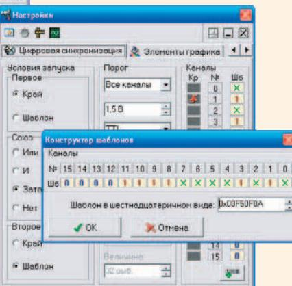
Цифровая синхронизация и конструктор логических шаблонов
