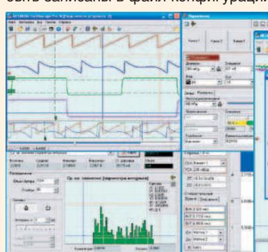
Измерение параметров импульса и статистика
