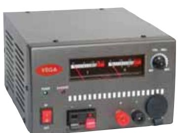
**PSS-3035** Блок питания импульсный, 220(110)В/13.8В, 30/35А. Защита: КЗ, перегрузка, превышение напряжения. Измерители В/А
