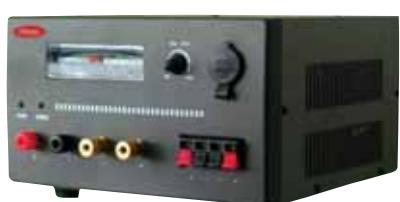
**PSS-6055** Блок питания импульсный, 220(110)В/13.8В, 50/60А. Защита: КЗ, перегрузка, превышение напряжения. Измерители В/А. Вес 5,2 кг.
