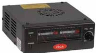
**PSS-825M** Блок питания импульсный низкопрофильный, 220(110)В/9-16В регулируемый, 22/27А. Измерители В/А. Защита: КЗ, перегрузка, превышение напряжения. Кронштейны для крепления радиостанции в комплекте
